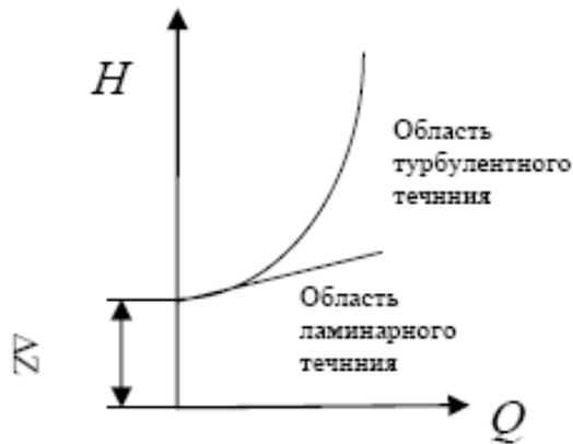
Рисунок 2.2 - Характеристика трубопровода
