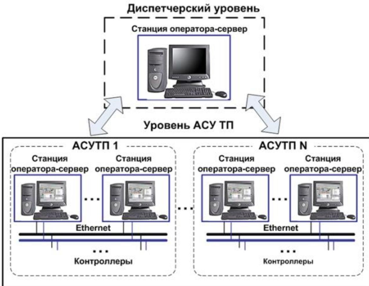
Рисунок 3.6 - SCADA системы
